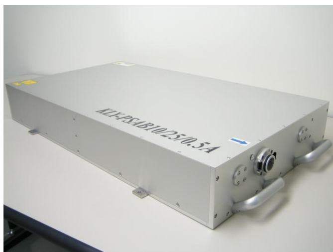
開発したピコ秒レーザーの発振器（縦 488mm × 横 868mm × 高さ 123mm）
